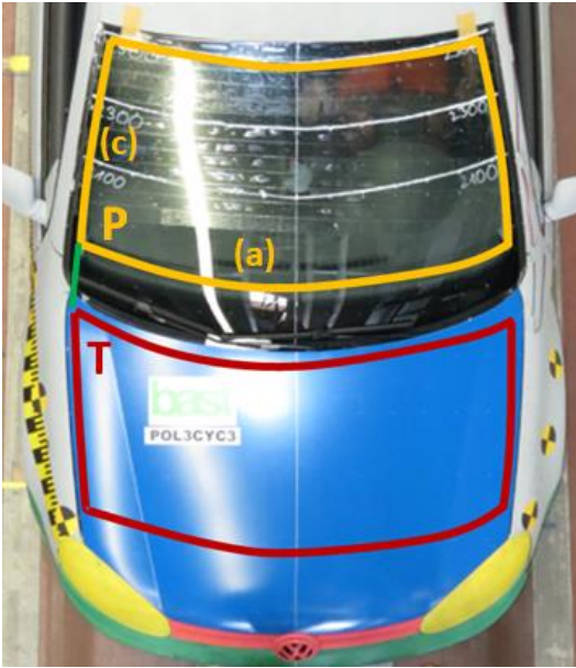
Рис. 14 Боковые границы зоны контрольного испытания накладки рамы
