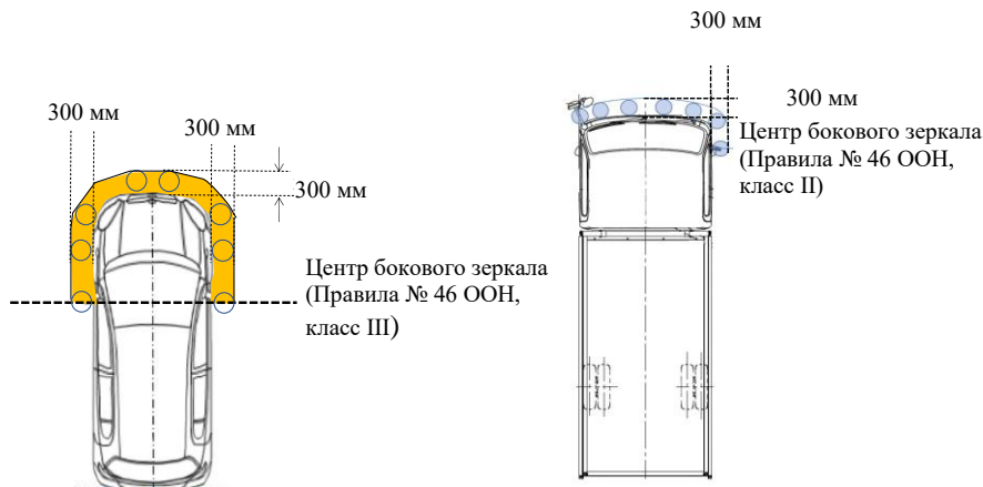
Рис. 6 Поле переднего и бокового обзора в непосредственной близости
