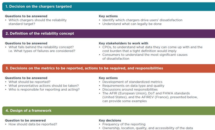
Figure XI Quatre étapes clés de la définition d'une norme de fiabilité
