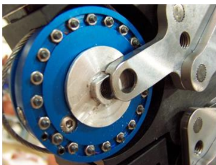
Рис. 32 Установка демпфера на место
