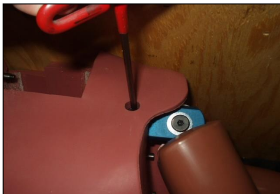
Рис. 60 Регулировка плечевого шарнира
