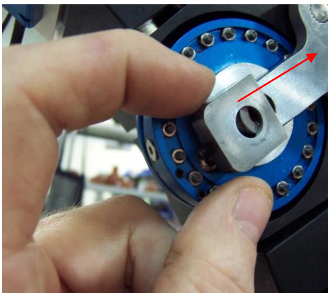
Рис. 14 Установочный винт зажима демпфера
