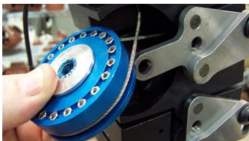
Рис. 32 Установка демпфера на место
