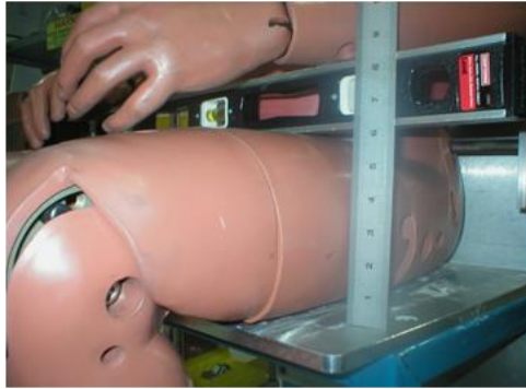
Рис. 8 Измерение наибольшего диаметра бедра (в положении сидя)
