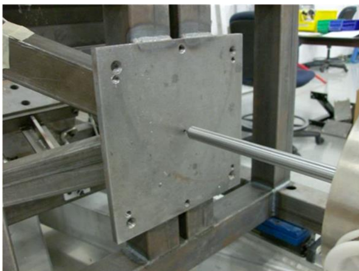
Рис. 7 Центрирование ударного штока
