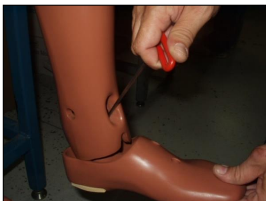
Рис. 66 Регулировка голеностопного шарнира
