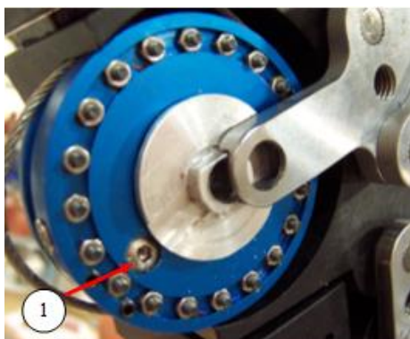
Рис. 9 Выставление регулировочного винта демпфера
