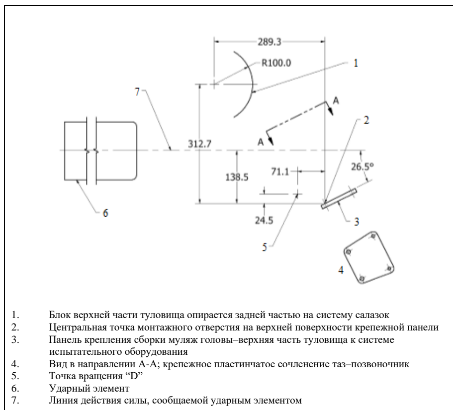
Рис. 2 Основные размеры механизма салазок (в мм)
