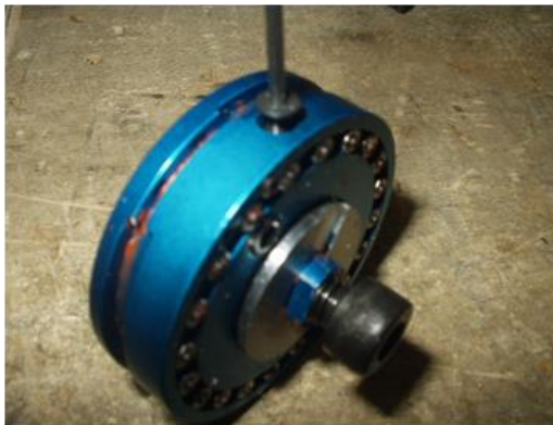
Рис. 33 Извлечение заглушки маслозаправочного отверстия
