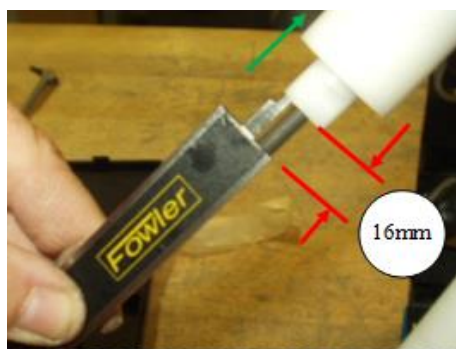
Рис. 24 Обеспечение тугого натяжения подпружиненного троса 1. Обжимная втулка и направляющая соприкасаются 2. Тянуть в направлении, обозначенном красной стрелкой
