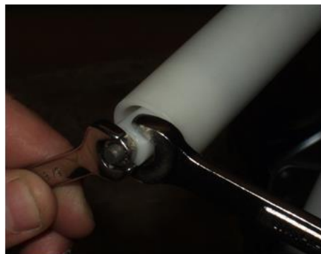
Рис. 43 Фиксация регуляторов натяжения подпружиненного троса
