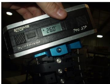
Рис. 47 Отклонение пластинчатого сочленения, имитирующего затылочный мыщелок, назад
