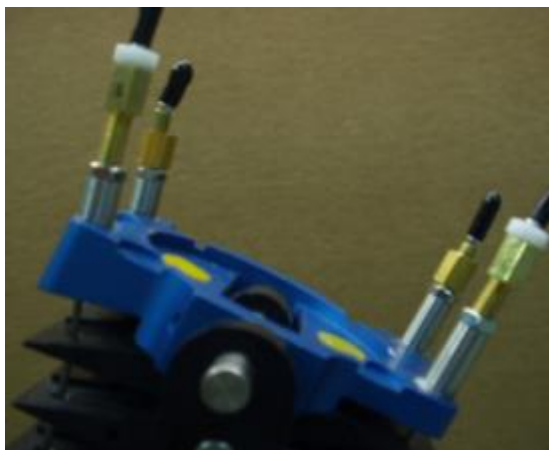
Рис. 49 Регуляторы натяжения троса демпфера
