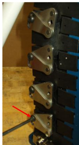
Рис. 36 Затягивание стопорных винтов
