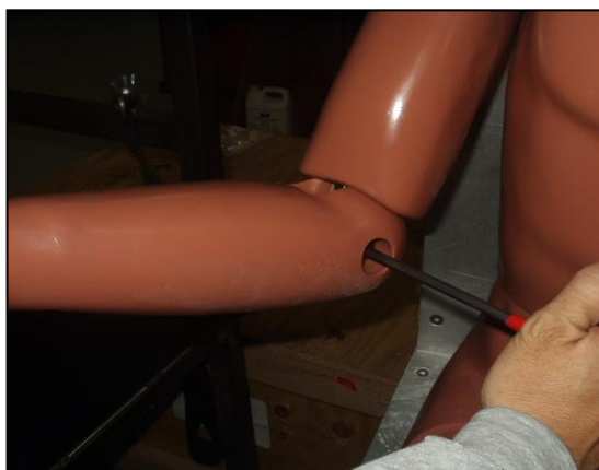
Рис. 62 Регулировка болта локтевого шарнира
