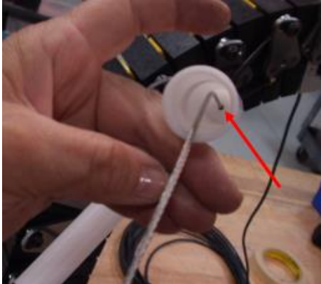
Рис. 21 Регулятор натяжения троса заподлицо с торцом втулки
