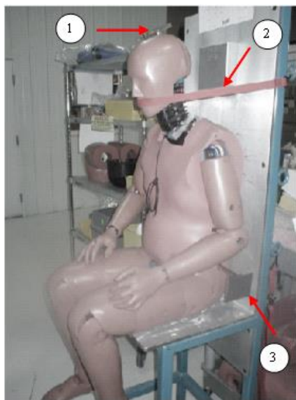
Рис. 2 Размещение манекена (в положении сидя) на стуле для снятия параметров
