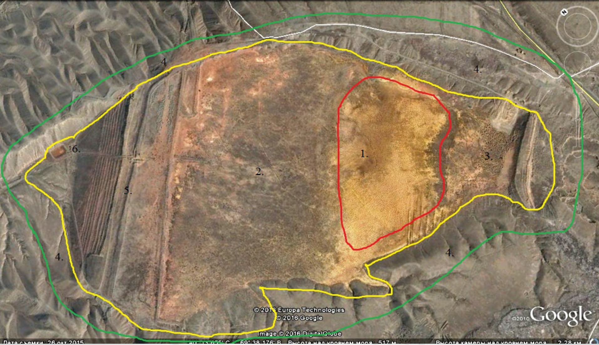
Карта мощности дозы (мкЗв/ч): 1. Непокрытый участок I (от 5,0 до 13). 2. Непокрытый участок II (от 0,5 до 5,0). 3. Покрытый грунтом 0,5 м участок (0,3 до 0,5). 4. Пограничная зона (от 0,15 до 0,3). 5. Дамба. 6. Резервуар для сбора воды.
