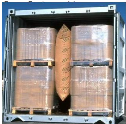
Рис. 7.912. Заполнение пустоты по центру с помощью пневмооболочки
