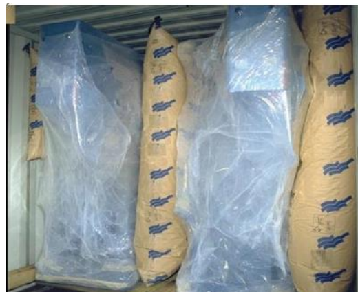
Рис. 7.913. Блокировка пневмооболочками упаковок неправильной формы
