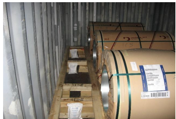
Рис. 7.41. Блокировка у ограничивающих конструкций
