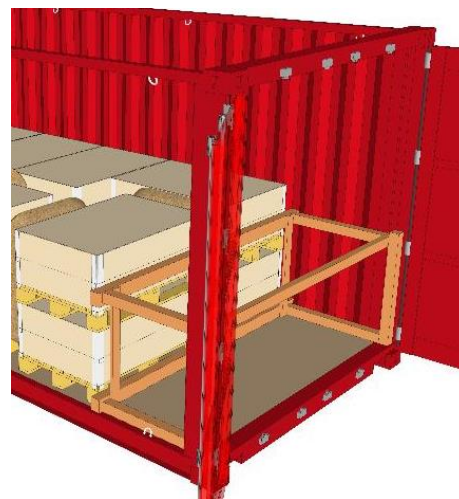
Рис. 7.50. Поперечные балки, вставленные в гофры и поддерживаемые подпорными балками у дверных петель
