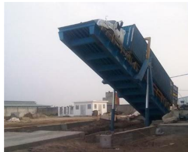
Рис. 7.87 100-тонная опрокидывающая платформа
