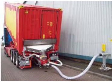
Рис. 7.83 Разгрузка с помощью промежуточного устройства
