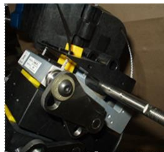
Figure 83 Retrait de la goupille de la vertèbre T1
