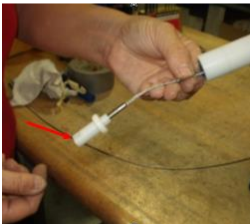
Figure 21 Mise à niveau du tendeur et de l'embout du câble
