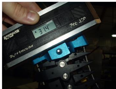
Figure 45 Inclinaison de la plaque d'assemblage occipito-cervicale vers l'avant
