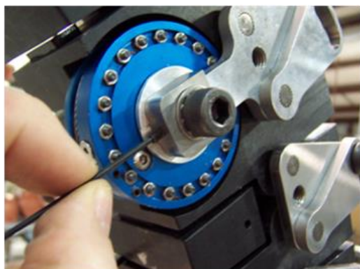
Figure 14 Vis d'arrêt du support de serrage
