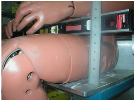
Figure 8 Mesure de la hauteur des cuisses
