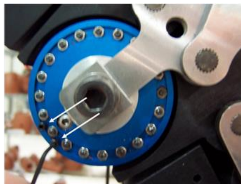
Figure 27 Desserrage des vis de blocage M3
