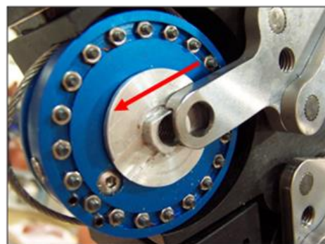
Figure 29 Retrait de la poulie amortisseur
