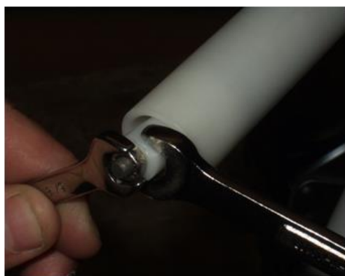
Figure 43 Blocage des tendeurs à ressort
