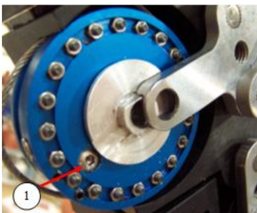
Figure 9 Réglage de la position de la vis de réglage de la poulie amortisseur
