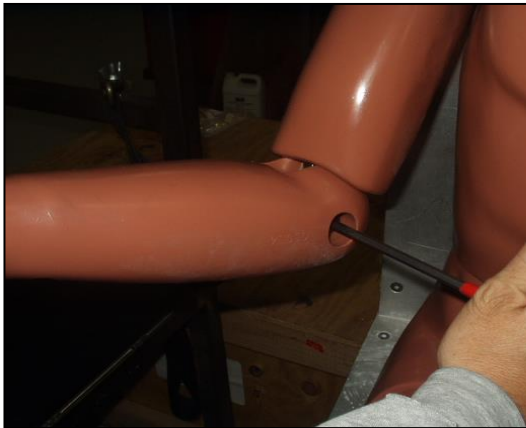
Figure 62 Réglage du coude (rotation transversale de l'avant-bras)
