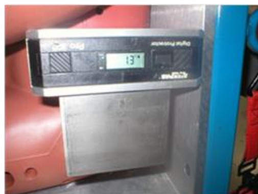
Figure 6 Mesure de l'angle de la cale de positionnement du point H
