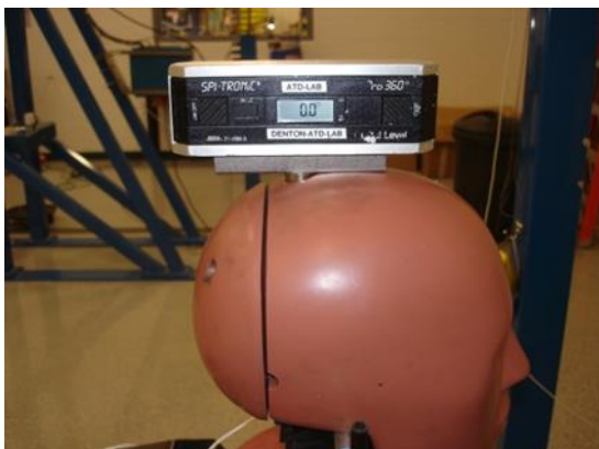
Figure 6 Réglage de l'inclinaison de la tête
