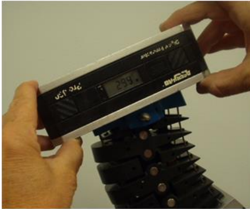
Figure 53 Réglage de l'inclinaison de la plaque d'assemblage occipito-cervicale
