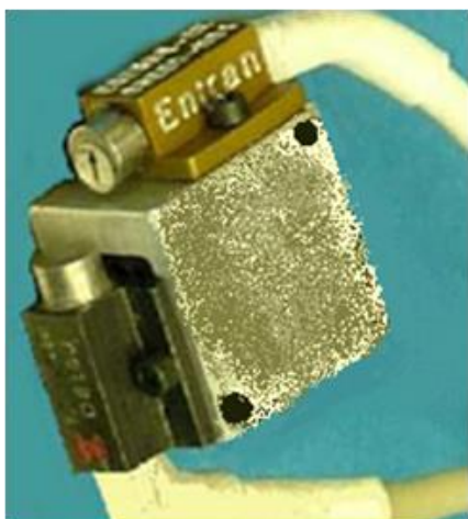
Figure 71 Montage de l'accéléromètre de la région cervicale
