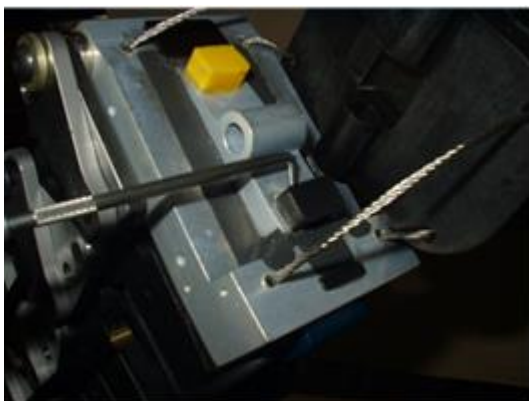
Figure 84 Retrait de l'amortisseur de la vertèbre T1 à l'aide d'un crochet pointu
