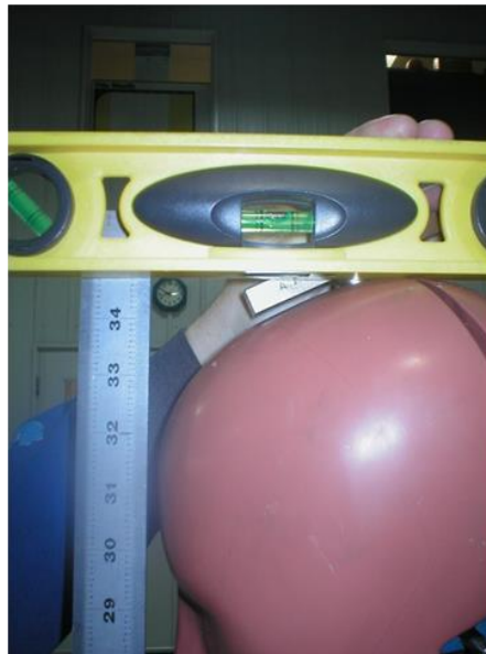
Figure 10 Mesure de la hauteur du mannequin en position assise
