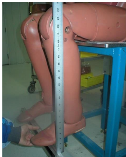
Figure 11 Mesure de la hauteur de l'axe de rotation du genou gauche
