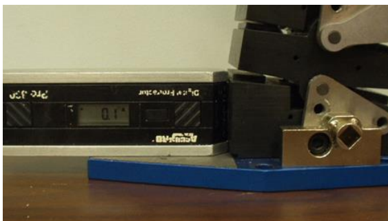
Figure 46 Réglage de la position des tendeurs avant (gauche) et arrière (droite) si la valeur de l'inclinaison vers l'avant n'est pas respectée
