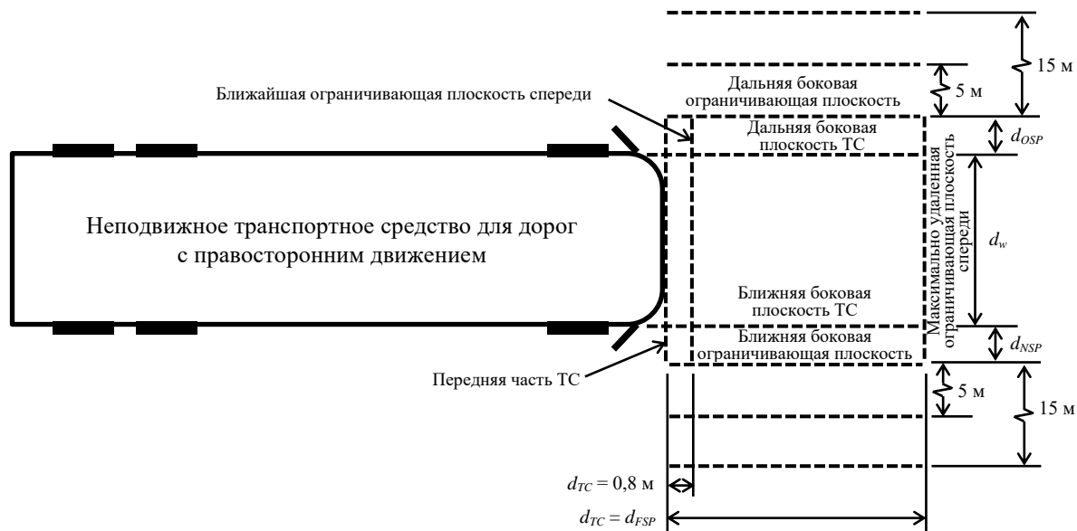
Рис. 1 Схема статических испытаний с пересечением
