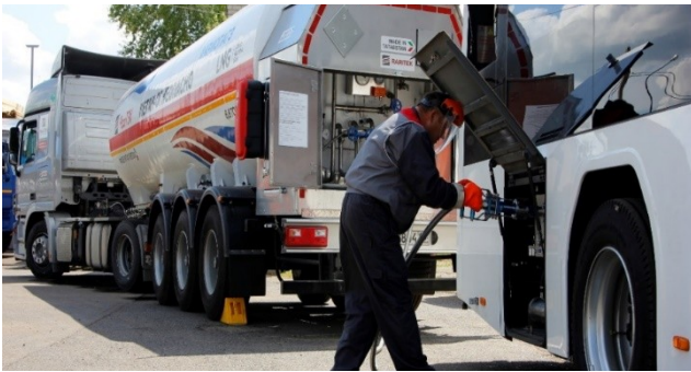
Криогенный передвижной газовый заправщик СПГ (КриоПАГЗ)
