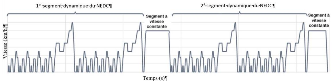
Les segments dynamiques du NEDC DS<sub>1</sub> et DS<sub>2</sub> sont utilisés pour calculer la consommation d'énergie électrique. Les segments à vitesse constante CSS<sub>M</sub> et CSS<sub>E</sub> sont destinés à réduire la durée de l'essai en épuisant la charge du SRSEE plus rapidement que dans la procédure d'essai avec cycles consécutifs du NEDC.
