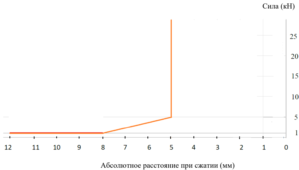
Рис. 4 Коридор для квазистатического испытания на разрушение
