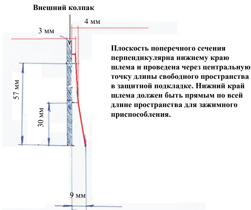
Рис. 6 Свободное пространство в предохранительной прокладке, предусмотренное для зажимного приспособления аксессуаров, устанавливаемых спереди и сбоку на шлемах UA
