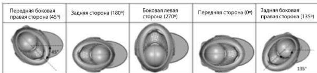
Рис. 4 Схемы удара при испытании на косо́й удар: ВИД СВЕРХУ — удары в точках
