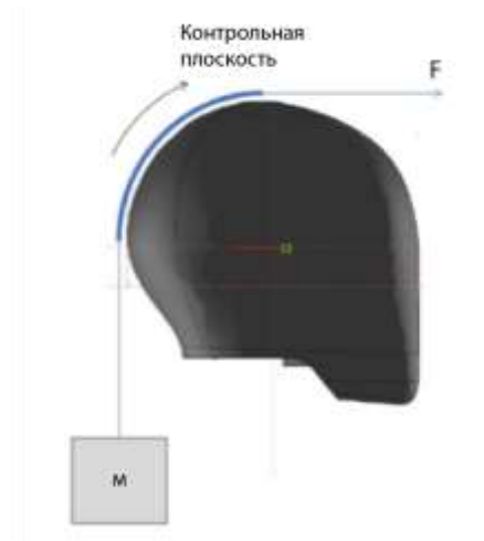
Рис. 1 Схема испытания на измерение коэффициента трения
