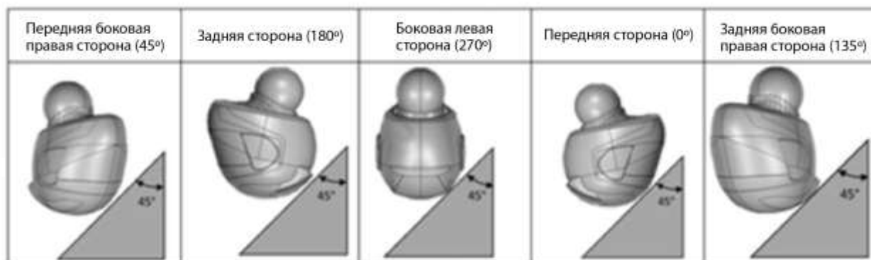
Рис. 4 Схемы удара при испытании на косо́й удар: ВИД СВЕРХУ — удары в точках
