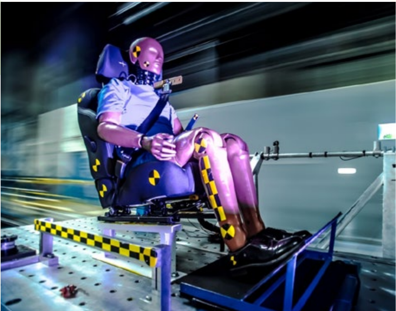
Catapulte inverse pour les essais de ceintures de sécurité © UTAC CERAM - France
