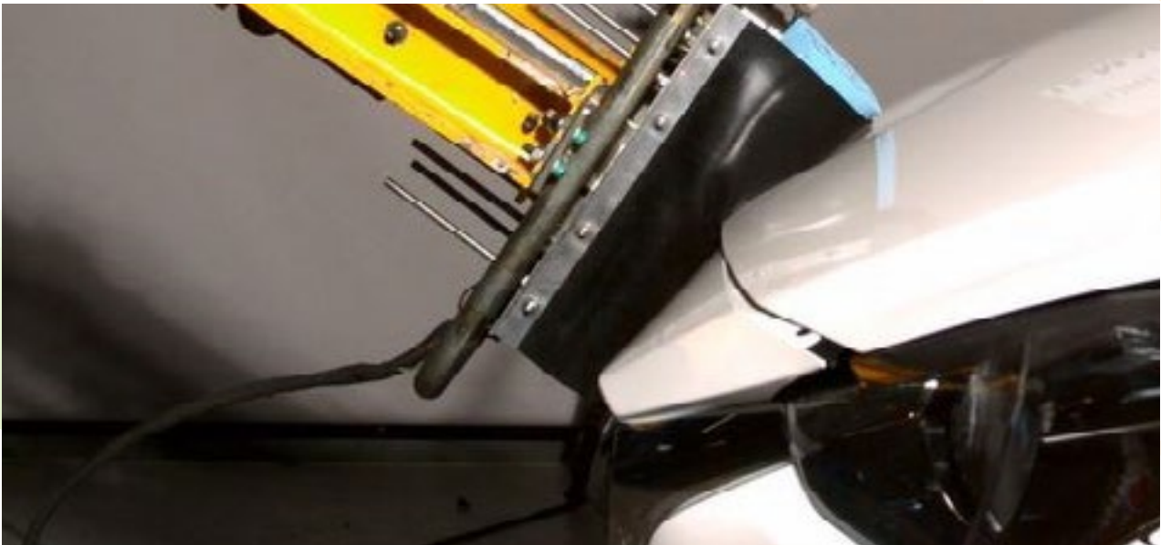
Dispositif supérieur de la jambe de piéton © UTAC CERAM - France
