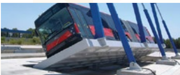
Essai de résistance de superstructure d'un bus © IDIADA-Spain
