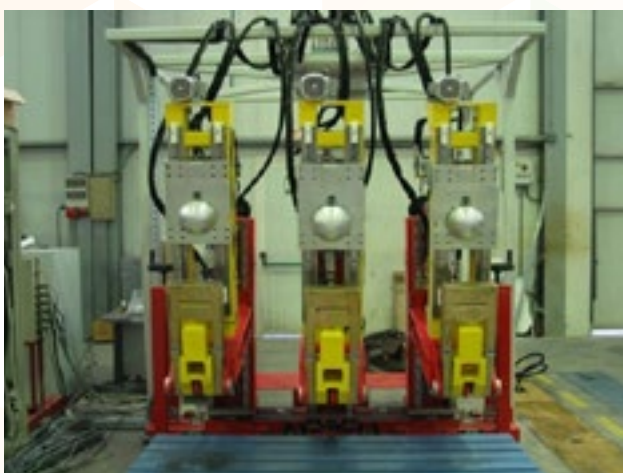
Machine de test d'ancrage des ceintures de sécurité ©INTA-Spain
