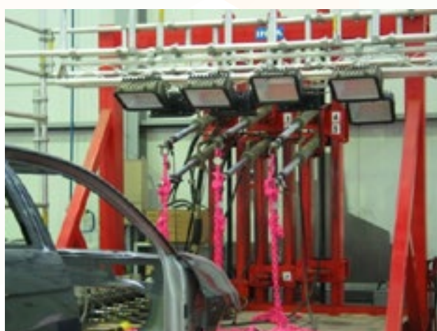
Machine de test d'ancrage des sièges ©INTA-Spain
