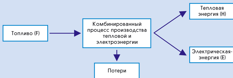
Рис. 2.4. • Упрощенная диаграмма определения частей от общего объема поставленного на ТЭЦ топлива, затраченных на производство соответственно электрической и тепловой энергии
