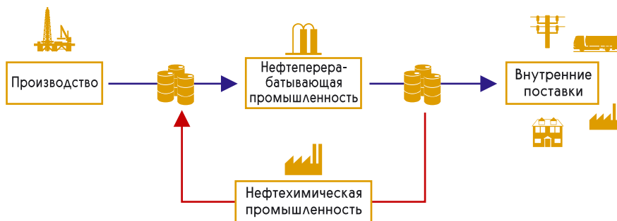
Рис. 4.1. ● Упрощенная схема потоков нефтепродуктов
