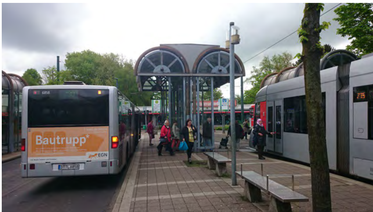
РИС. 3.16 ДЮССЕЛЬДОРФ, ГЕРМАНИЯ. КРОСС-ПЛАТФОРМЕННАЯ ПЕРЕСАДКА С АВТОБУСА НА ТРАМВАЙ ПОЗВОЛЯЕТ ВЫПОЛНИТЬ ПЕРЕСАДКУ МАКСИМАЛЬНО БЫСТРО И БЕЗОПАСНО, МИНИМИЗИРУЕТ ЛИШНИЕ МАРШРУТЫ И ПОВЫШАЕТ ОБЩИЙ УРОВЕНЬ ЭФФЕКТИВНОСТИ МАРШРУТНОЙ СЕТИ
