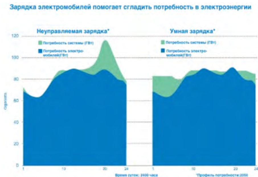
РИС. 5.16 ВЛИЯНИЕ ЗАРЯДКИ ЭЛЕКТРОМОБИЛЕЙ НА УПРАВЛЕНИЕ ЭЛЕКТРОСЕТЯМИ
