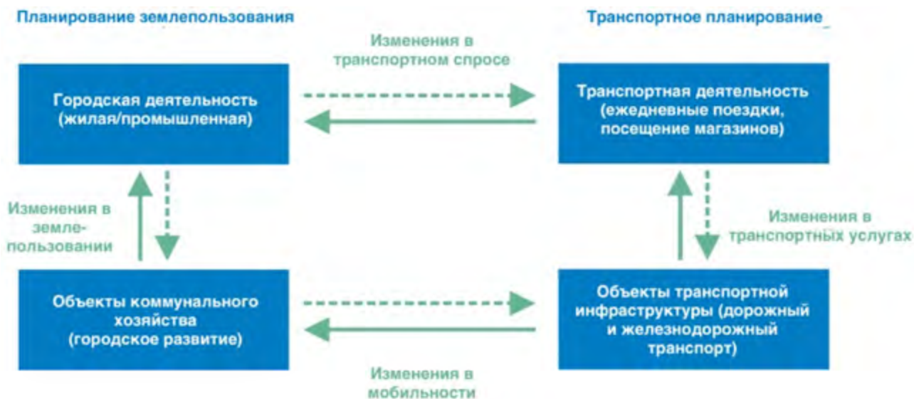
РИС. 7.1 СВЯЗЬ МЕЖДУ ЗЕМЛЕПОЛЬЗОВАНИЕМ И ТРАНСПОРТНЫМ ПЛАНИРОВАНИЕМ 172
