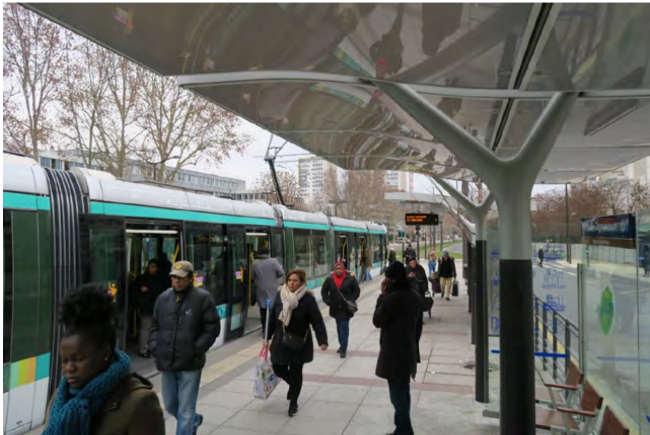
РИС. 3.15 ПАРИЖ. ВСЕ ТРАМВАЙНЫЕ ОСТАНОВКИ ОБОРУДОВАНЫ ПЛАТФОРМАМИ, РАСПОЛОЖЕННЫМИ ВРОВЕНЬ С ПОЛОМ ТРАНСПОРТНОГО СРЕДСТВА, ЧТО ОБЕСПЕЧИВАЕТ ЛЕГКИЙ ДОСТУП И СОКРАЩАЕТ ВРЕМЯ ПОСАДКИ. КАЖДАЯ ПЛАТФОРМА ОБОРУДОВАНА СПЕЦИАЛЬНОЙ ЗОНОЙ ОЖИДАНИЯ ДОСТАТОЧНОЙ ШИРИНЫ И С ДОСТАТОЧНОМ КОЛИЧЕСТВОМ ПОСАДОЧНЫХ МЕСТ. СТАНДАРТНАЯ ОСТАНОВКА ОБОРУДОВАНА ИНФОРМАЦИОННЫМ ТАБЛО, НА КОТОРОМ ОТОБРАЖАЮТСЯ ОБСЛУЖИВАЕМЫЕ МАРШРУТЫ
