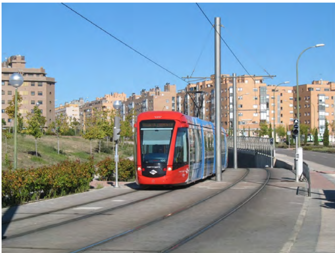
РИС. 3.1 МАДРИД, ИСПАНИЯ. ЭТОТ РАЙОН СО ВСЕЙ НАГЛЯДНОСТЬЮ ИЛЛЮСТРИРУЮТ ОБА ПОДХОДА К ПОВЫШЕНИЮ ДОСТУПНОСТИ В ГОРОДЕ. ПЛОТНОСТЬ ЗАСЕЛЕНИЯ УВЕЛИЧИЛАСЬ БЛАГОДАРЯ 5 - 6-ЭТАЖНЫМ МНОГOKВАРТИРНЫМ ДОМАМ, А БОЛЕЕ ВЫСОКАЯ СКОРОСТЬ ПЕРЕДВИЖЕНИЯ ДОСТИГАЕТСЯ ЗА СЧЕТ ЛИНИИ ЛЕГКОГО РЕЛЬСОВОГО ТРАНСПОРТА НА ОБОСОБЛЕННОМ ОТ АВТОТРАНСПОРТА ПОЛОТНЕ.
