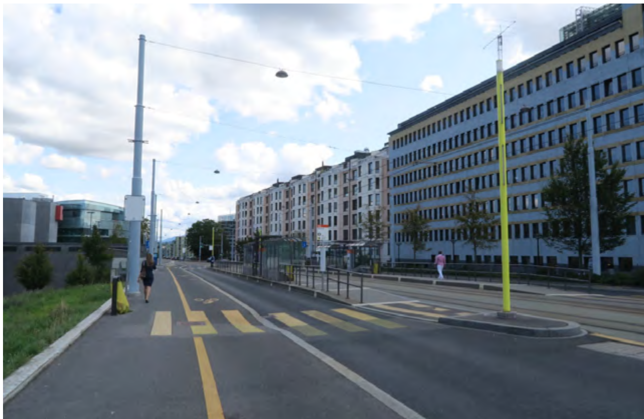
РИС. 3.5 ЖЕНЕВА, ШВЕЙЦАРИЯ. ДОРОЖНОЕ ПРОСТРАНСТВО ПОДЕЛЕНО С УЧЕТОМ ВСЕХ ВИДОВ ДВИЖЕНИЯ: РЕЛЬСОВОГО, ПЕШЕХОДНОГО, ВЕЛОСИПЕДНОГО И АВТОМОБИЛЬНОГО. ДЛЯ АВТОМОБИЛЕЙ ПРЕДУСМОТРЕНА ТОЛЬКО ОДНА ПОЛОСА
