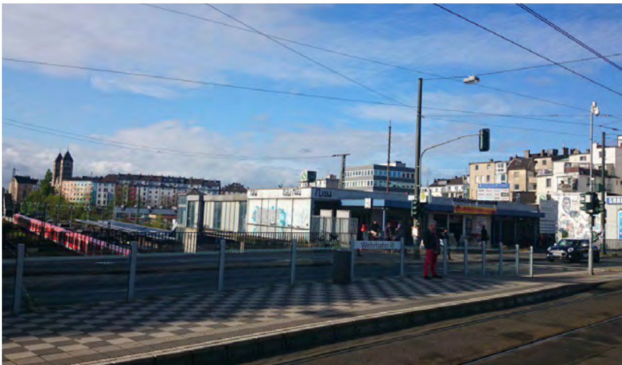
РИС. 3.27 ДЮССЕЛЬДОРФ. ТРАМВАЙНАЯ ОСТАНОВКА РАСПОЛОЖЕНА НА МОСТУ ЧЕРЕЗ ЖЕЛЕЗНОДОРОЖНЫЕ ПУТИ ДЛЯ МИНИМИЗАЦИИ РАССТОЯНИЯ ШАГОВОЙ ДОСТУПНОСТИ ПРИ ПЕРЕСАДКЕ
