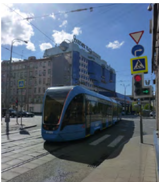
РИС. 3.50 МОСКВА. ОРГАНИЗАЦИЯ ПРИОРИТЕТНОГО ПРОЕЗДА ОБЩЕСТВЕННОГО ТРАНСПОРТА НА ПЕРЕКРЕСТКЕ: ПЕРЕСЕКАТЬ УЛИЦУ ПРЯМО ПОЗВОЛЯЕТСЯ ТОЛЬКО ОБЩЕСТВЕННОМУ ТРАНСПОРТУ. АНАЛОГИЧНЫЙ МЕТОД БЫЛ ТАКЖЕ ЭФФЕКТИВНО РЕАЛИЗОВАН В ТОРОНТО
