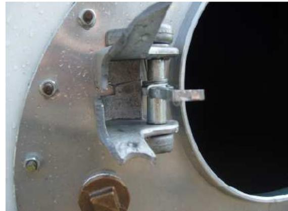
Bild 4: Bruch des Verschlussbügels nach dem Test
