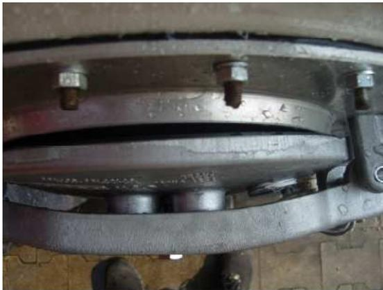
Bild 3: Versagen des Fülllochdeckels nach dem Test
