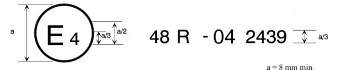
La marque d'homologation ci-dessus, apposée sur un véhicule, indique que le type de ce véhicule a été homologué aux Pays-Bas (E4), en ce qui concerne l'installation de dispositifs d'éclairage et de signalisation lumineuse, en application du Règlement n° 48 tel qu'il a été modifié par la série 04 d'amendements. Le numéro d'homologation indique que l'homologation a été accordée conformément aux prescriptions du Règlement n° 48 tel qu'il a été modifié par la série 04 d'amendements.
