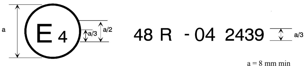
La marque d'homologation ci-dessus, apposée sur un véhicule, indique que le type de ce véhicule a été homologué aux Pays-Bas (E4), en ce qui concerne l'installation de dispositifs d'éclairage et de signalisation lumineuse, en application du Règlement n° 48 tel qu'il a été modifié par la série 04 d'amendements. Le numéro d'homologation indique que l'homologation a été accordée conformément aux prescriptions du Règlement n° 48 tel qu'il a été modifié par la série 04 d'amendements.
