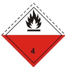
(4.2 号) 4.2 项 易于自燃物质 符号(火焰): 黑色; 底色: 上半部分为白色, 下半部分为红色; 数字“4”写在底角
