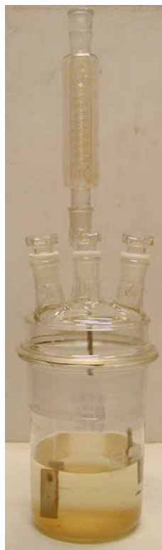
Figure 37.4.2: RÉACTEUR AVEC RÉFRIGÉRANT À REFLUX
