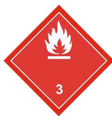
Pictograma para líquidos inflamables en la Reglamentación Modelo (Símbolo (llama): negro o blanco; Fondo rojo; Cifra “3” en el ángulo inferior; dimensiones mínimas 100 × 100 mm)
