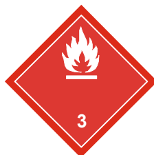
Pictograma para líquidos inflamables en la Reglamentación Modelo (Símbolo (llama): negro o blanco; Fondo rojo; Cifra “3” en el ángulo inferior; dimensiones mínimas 100 × 100 mm)
