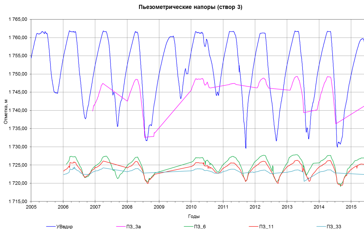
Рис. 3. График пьезометрических уровней земляной плотины створ 3*
