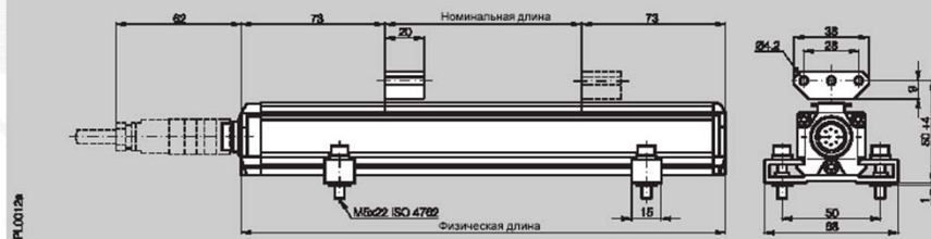
Измеритель пути с закрепленным магнитом; разъемное подключение S 32 с разъемом BKS-S 33M Аналоговый, цифровой импульсный и SSD-интерфейс стр. P.4...P.9
