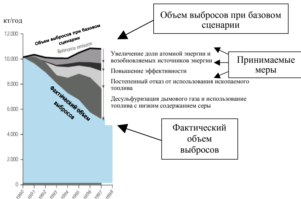
Диаграмма 4. Пример показателя эффективности политики: объем выбросов диоксида серы обычными электростанциями в 15 странах ЕС
