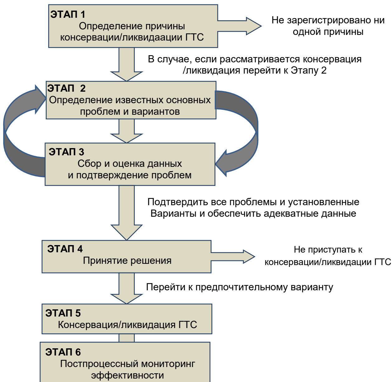
Рис. 4.1. Процесс принятия решений по консервации/ликвидации ГТС
